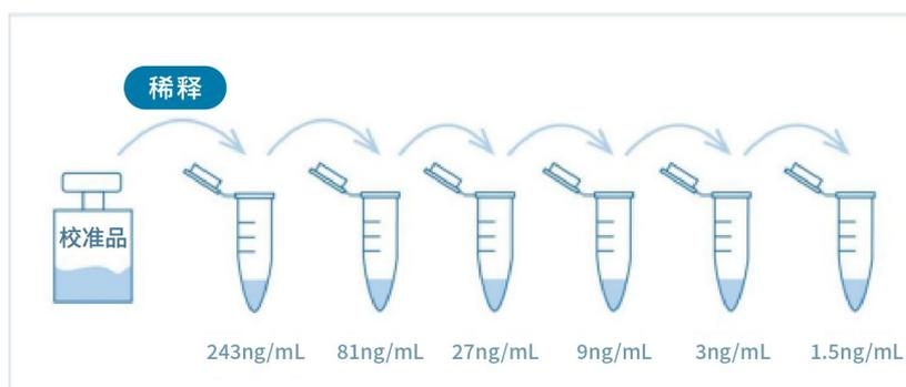
图 3 校准品稀释操作示例
